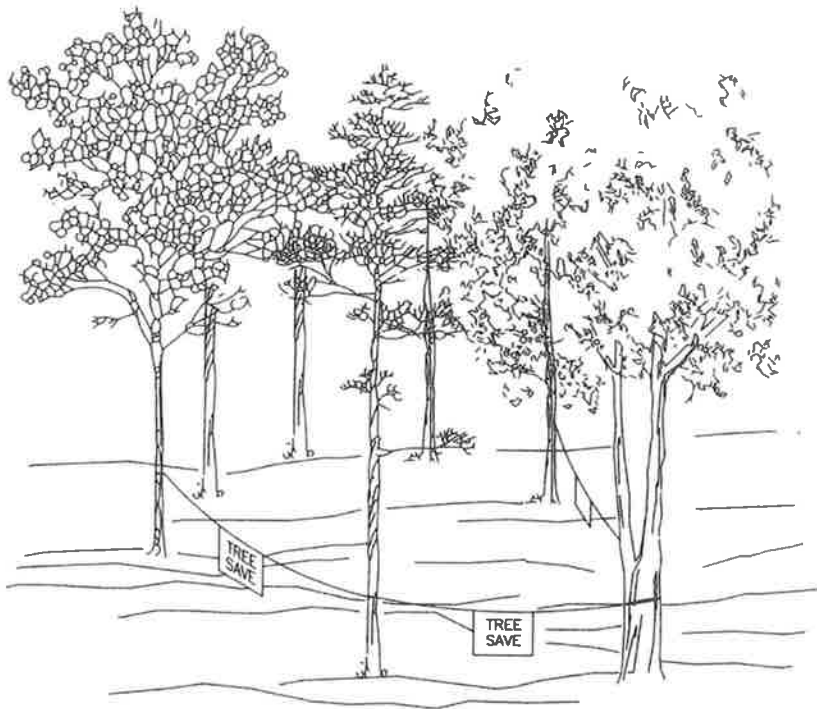
○ PASSIVE TREE PROTECTION FLAGGING N.T.S.
